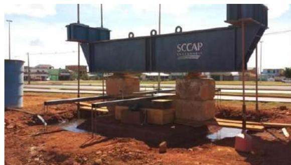
A prova de carga foi realizada sobre uma sapata de concreto armado com seção transversal de 150 cm x 150 cm (22.500 cm<sup>2</sup> de área), assente sobre um aterro compactado. Destaca-se que as dimensões do aterro tal como suas especificações de compactação, foram definidas pelo projetista de fundações e foram executadas pela obra.
